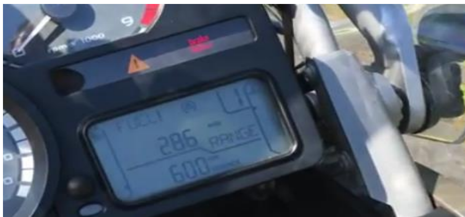
Fig. 1 Het display met de hinderlijke gele driehoek, te wijten aan een defect foliesensor.
